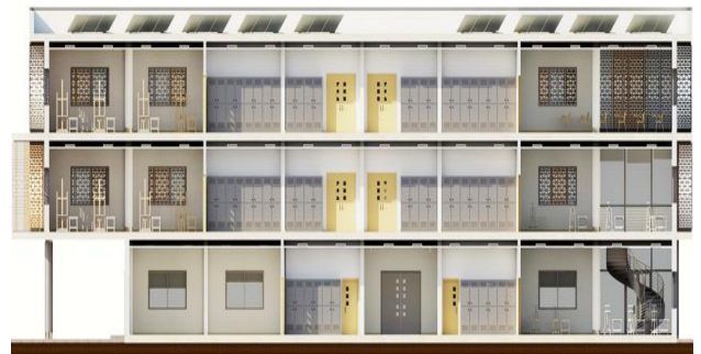
شكل (20) القطاع الرأسي A-A للمبنى. تصميم ورسم الباحث.
