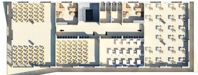
شكل (19) المسقط الأفقي للطابق الثاني، وتقدر مساحته بـ 710 م 2 ، ويحتوي على مرسم التصوير، وقاعة تصميم اللوحات الجدارية، والزجاج المعشق، وقاعة للدراسة النظرية، وقاعة متعددة الأغراض، وغرفتي مكاتب، وحمام للرجال وآخر للسيدات. تصميم ورسم الباحث.
