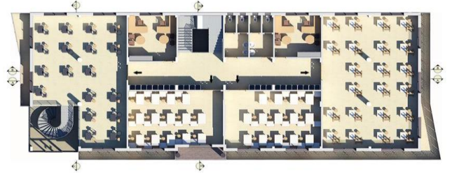
شكل (18) المسقط الأفقي للطابق الأول، وتقدر مساحته بـ 700 م 2 ، ويحتوي على الجزء العلوي من مرسم النحت، وقاعة للرسم الهندسي، وتصميم اللوحات الجدارية والزجاج المعشق، ومرسم التصوير، وغرفتي مكاتب، وحمام للرجال وآخر للسيدات. تصميم ورسم الباحث
